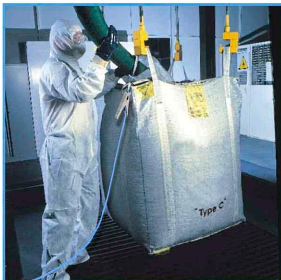
10. La pince doit être mise hors service en cas d'apparition de corrosion ou si la pince est endommagée.
