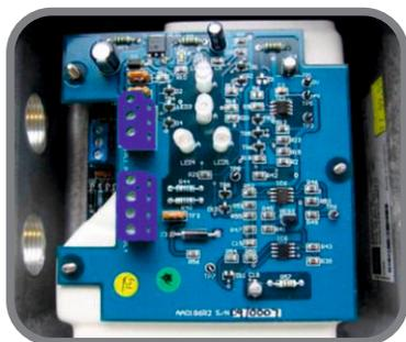
CIRCUIT IMPRIMÉ DE COMMUTATION À SÉCURITÉ INTRINSÈQUE EN OPTION
