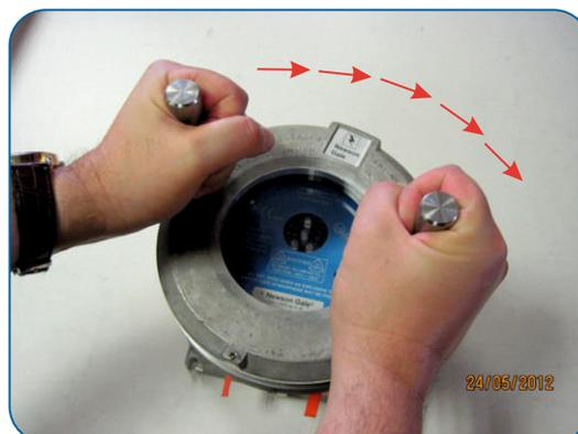
Une fois les clavettes de couvercle fixées en sécurité, tourner dans le sens horaire pour serrer le couvercle du boîtier.
