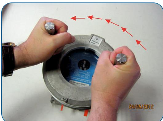
Une fois les clavettes de couvercle fixées en sécurité, tourner dans le sens antihoraire pour desserrer le couvercle du boîtier.
